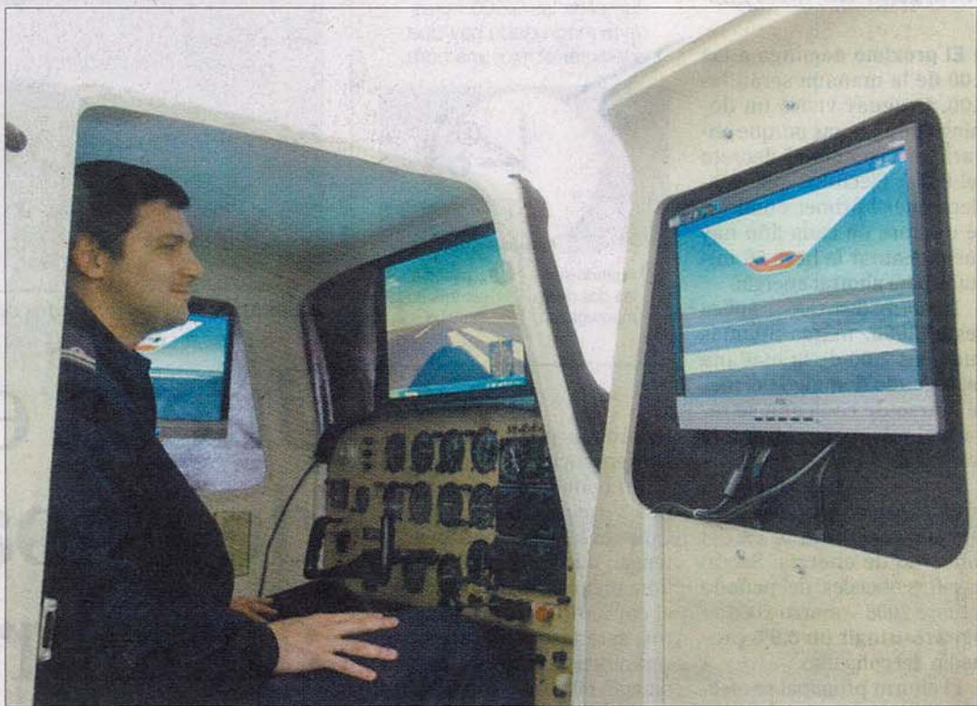
Simulador de vuelo. La cabina tiene, además del instrumental, pantallas de visualización.
